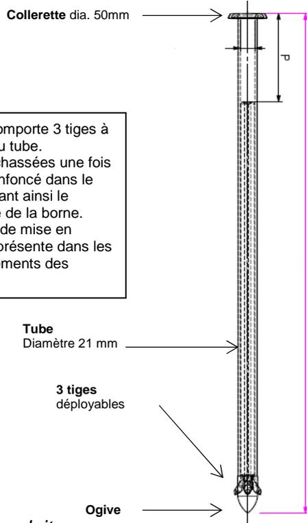
L'amarre comporte 3 tiges à l'intérieur du tube. Elles sont chassées une fois l'ancrage enfoncé dans le sol permettant ainsi le verrouillage de la borne. Une notice de mise en œuvre est présente dans les conditionnements des bornes.
